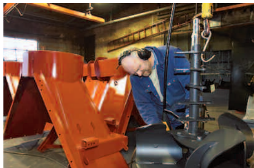
SNØFRESAR. Ulike typar snøfresarar har lenge vore eit sentralt produkt frå Lid Jarnindustri AS. Her er Odd Træbakken i gang med å møntere vifter på snøfresarane.
