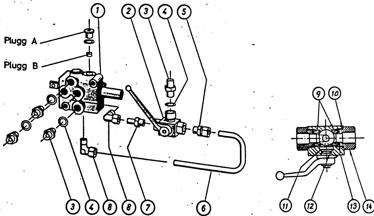
Ventilen leveres normalt med åpent senter. Oljen sirkulerer da fritt når ventilen er i midtstilling (syylinderen står i ro).
