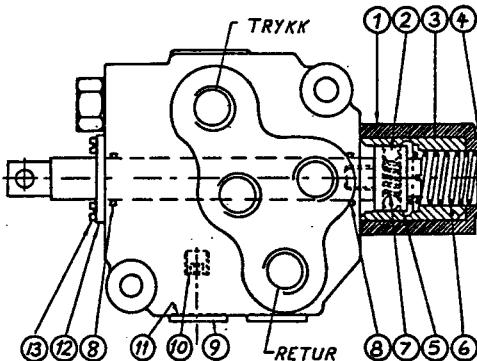
Ventilen leveres normalt med åpent senter. Oljen sirkulerer da fritt når ventilen er i midtstilling (syylinderen står i ro).
