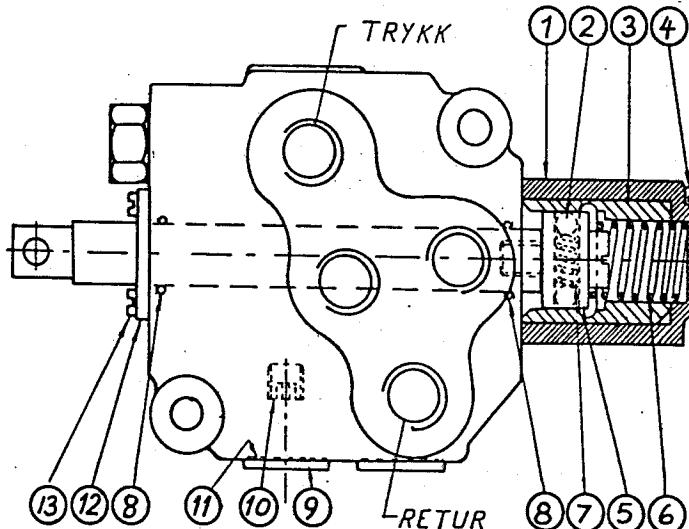
Ventilen leveres normalt med åpent senter. Oljen sirkulerer da fritt når ventilen er i midtstilling (sylinderen står i ro).
