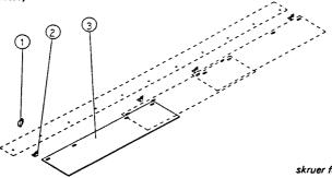
Festekroker monteres på skruer for tetningsplate slik fig. viser. Dekkplate kan så flyttes etter behov.
