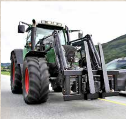
Trafikksikkerhet: Dalen Smartgaffel i løftet stilling under kjøring på offentlig vei.
