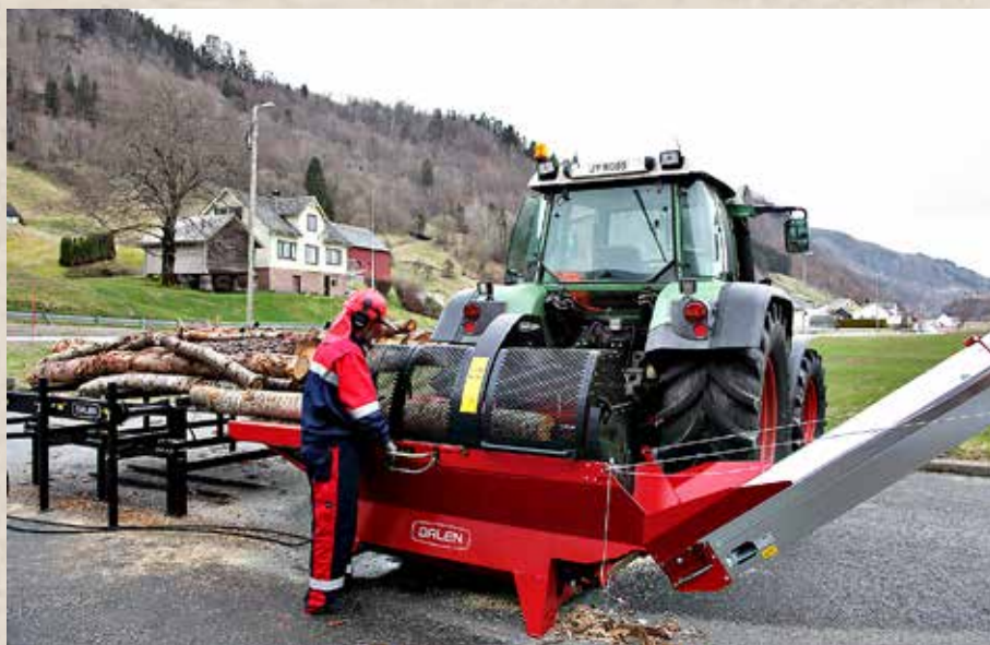
Dalen 2054: I 2003 lanserte Lid den første vedmaskina med hydraulisk kjedesverd.
