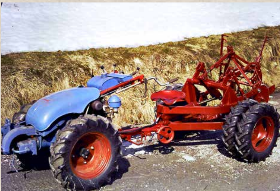
Firehjulstrekk: Dalen kardangvogn med hydraulikk/trepunkt og tvillinghjul. En liten jordbrukstraktor med lavt tyngdepunkt.
