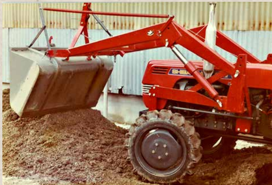
For frontlaster: Skuffer var Lids første redskap for frontlastere på firehjulstraktor.
