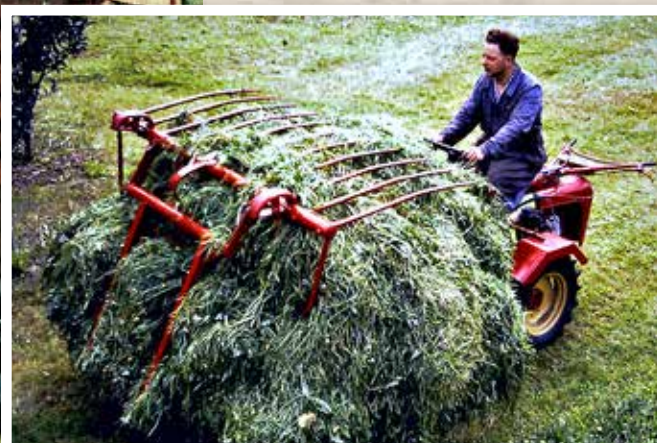
Grastransport: Hydraulikk på frontvogner skapte Lids egen parallell til Høysvansen.
