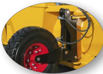
Mulighet for hydraulisk styring av hjul - full kontroll over hellingen
