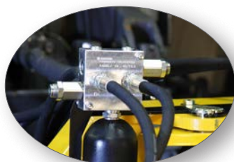
Doble sjokkbelastningsventiler med akkumulator både på skjær og bom.
