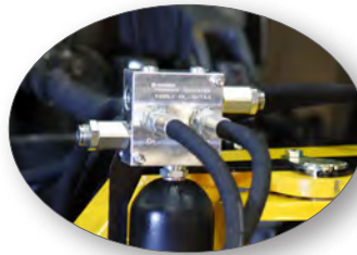
Kan fås med sjokkbelastnings- ventil med akkumulator
