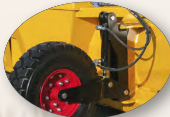
Mulighet for hydraulisk styring av hjul - full kontroll over hellingen
