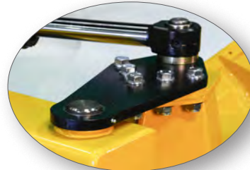
Ekstra kraftig innfesting og opplagring av sylinder og bom
