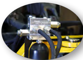
Kan få med sjokkbelastningsventil med akkumulator
